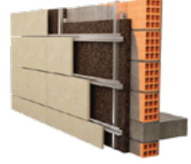
Obvodový plášť s pohľadovým obkladom – fasáda s vlnkovým vzorom s1
