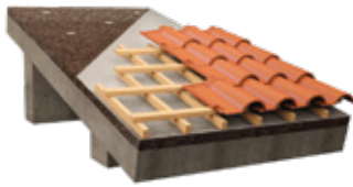
Šikmé strechy s odvetranou medzerou s použitím poistnej hydroizolačnej strešnej fólie
