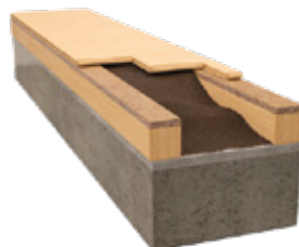
Základová doska a podlaha - odhlučnenie roštovania pre finálnu podlahu pomocou podložiek z kosových vlákien
