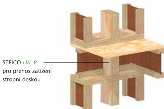
F5 Přenos vysokých bodových zatížení stropní deskou
