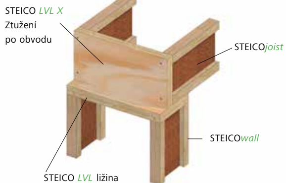
F1 Strop s napojením po obvodu
