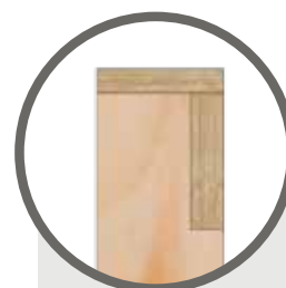
Sloupek s výřezem a s průběžným vazníkem
