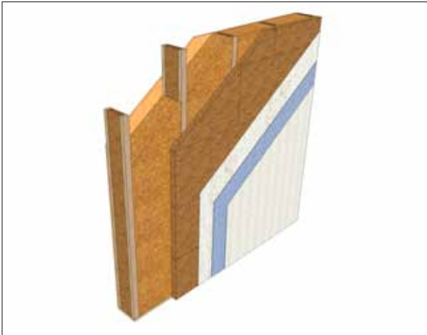
dřevěná rámová konstrukce bez deskového materiálu zvnějšku
